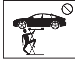
Het is verboden om in de lift te klimmen.
